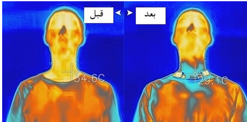
شکل الف-۴- حدود 5^{\circ}\text{C} خنک‌سازی ناحیه تماس با گردنی خنک
